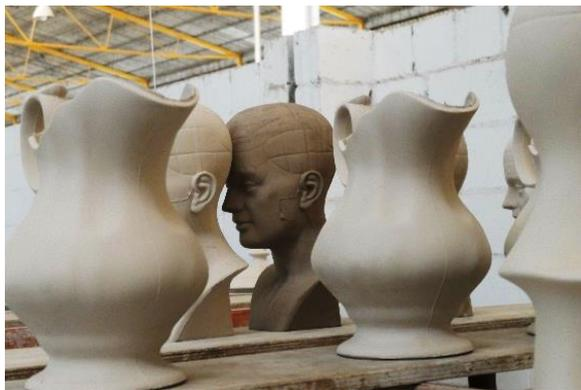
La producción se realiza mediante colada vertida en un molde de escayola, utilizando una arcilla líquida de características especiales importadas y únicas para La Cartuja.<sup>12</sup> Tras el vertido en los moldes, el operario espera un tiempo medido hasta que la *barbotina* se adiera a las paredes y alcance el grosor deseado. Se vierte la pieza y se vacía el líquido sobrante.
